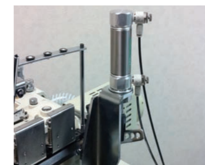
■ FL エアー式押え上装置 AIR TYPE FOOT LIFTER FL: LEVANTA PIE NEUMATICO 气压式抬压脚装置
